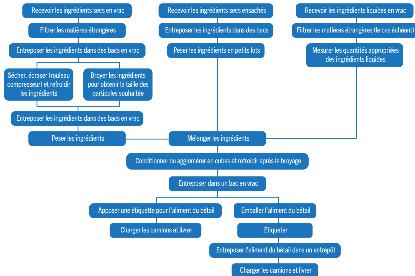
Figure 5. Processus typique de fabrication d'aliments du bétail, de la réception des ingrédients à l'expédition finale.
