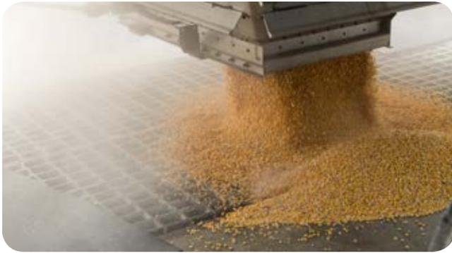
La photo ci-dessus montre un camion de livraison déchargeant un ingrédient à côté du puits de réception. Sur la photo ci-dessous, le camion est correctement positionné.
